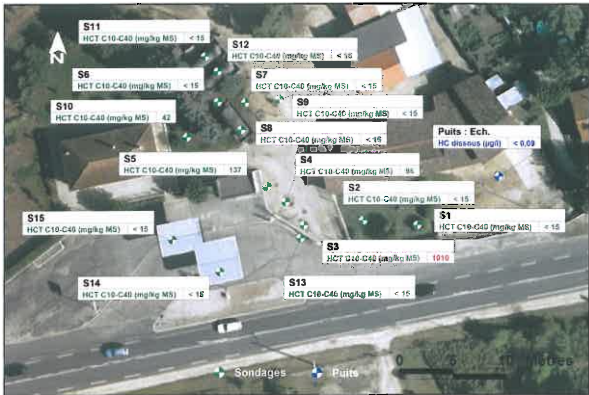
Figure 23 : Cartographie des résultats sur les matrices sol et eau (14.111.RA.001.01/fg23)
