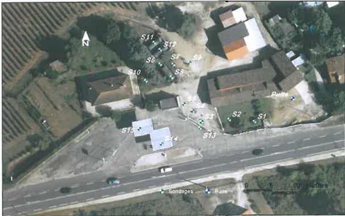
Figure 16 : Implantation des points de prélèvement (14.111.RA.001.01/fig16)
